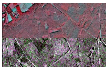
Abb. 3: Sehr gute Einpassung der TerraSAR-X Daten in die Kartenprojektion, hier verdeutlicht in der Gegenüberstellung mit Orthofotos (oben)
