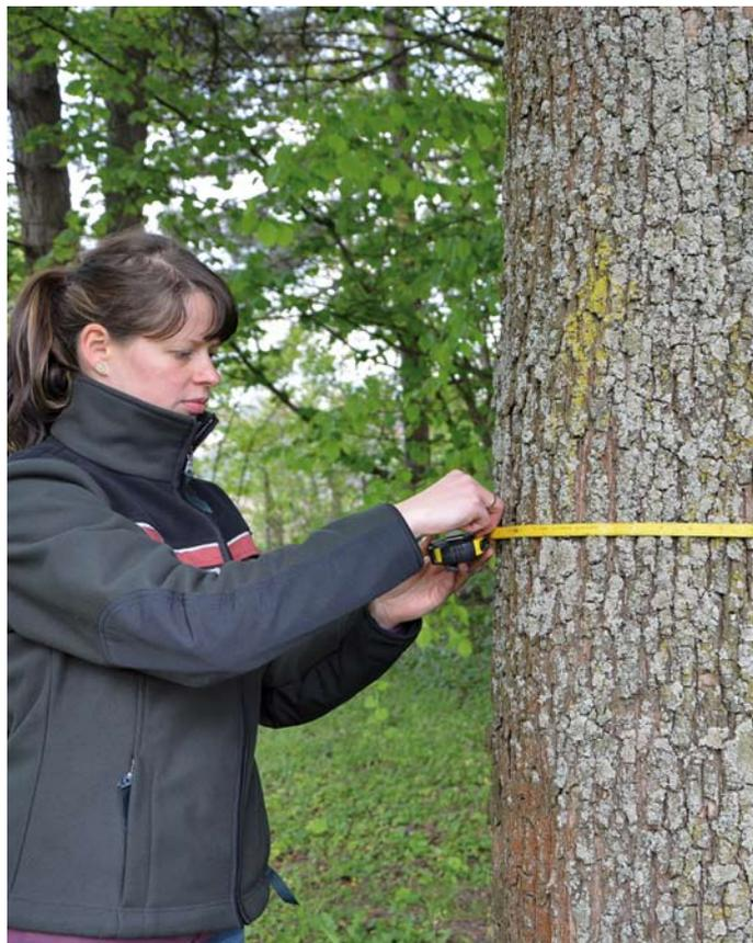
Erfassung des Durchmessers mit dem Maßband
