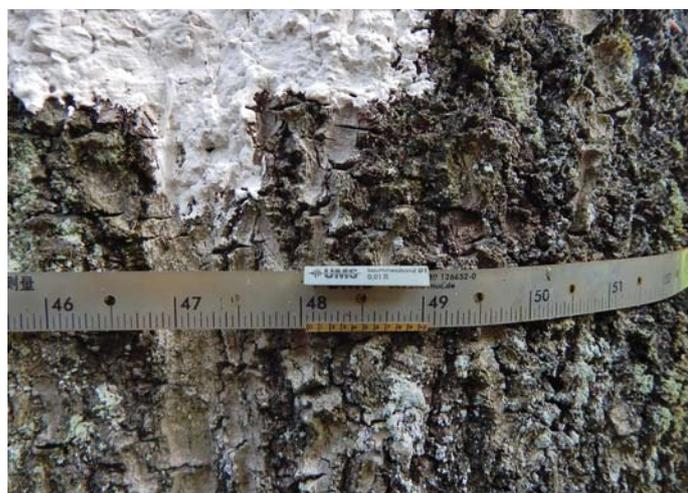
„Mitwachsendes“ Dauerumfangmessband zur millimetergenauen Erfassung des Dickenzuwachses
