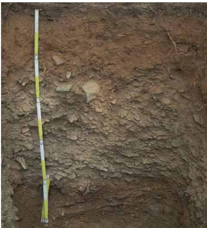
Typisches BZE-Tonschieferprofil bei Hayn im Harz, eine Braunerde mit hohen Steinanteilen im Unterboden, der gut durchwurzelt ist
