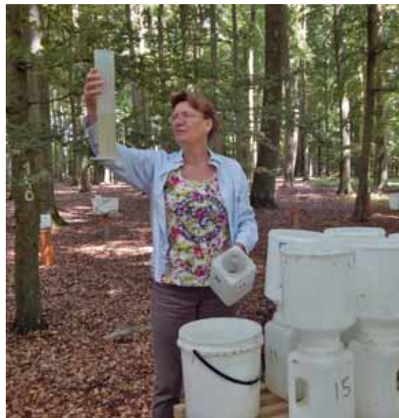
Intensiv-Monitoringfläche Bornhöved: Erfassung der Niederschlagsmenge Foto: O. Schwerdtfeger
