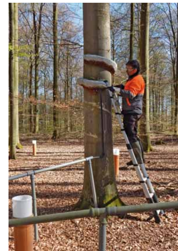
Intensiv-Monitoringfläche Bornhöved: Wartung der Stammablaufmessung Foto: O. Schwerdtfeger
