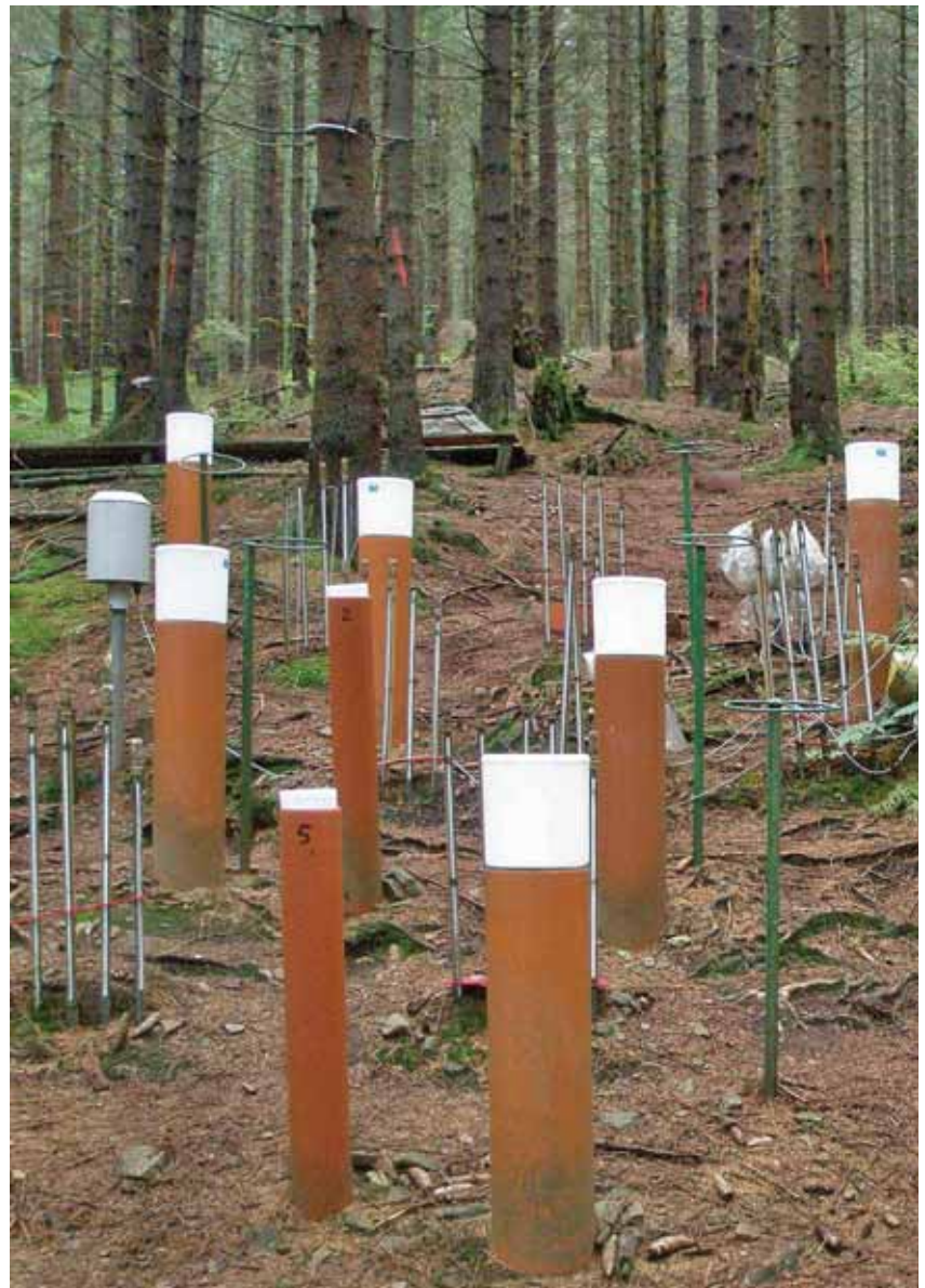
Depositions-Messfläche mit Schwermetallsammlern (Nr. 5 und Nr. 2) Foto: NW-FVA
