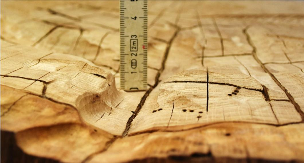
**Abb. 15:** Auch Brutgänge einer „Ebene“ können um mehrere cm nach oben und unten abweichend verlaufen
