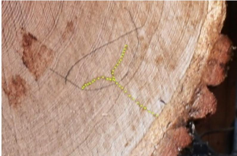
**Abb. 11:** Gelb markierte, über den Bohrgang hinausgehende Verfärbungen.
