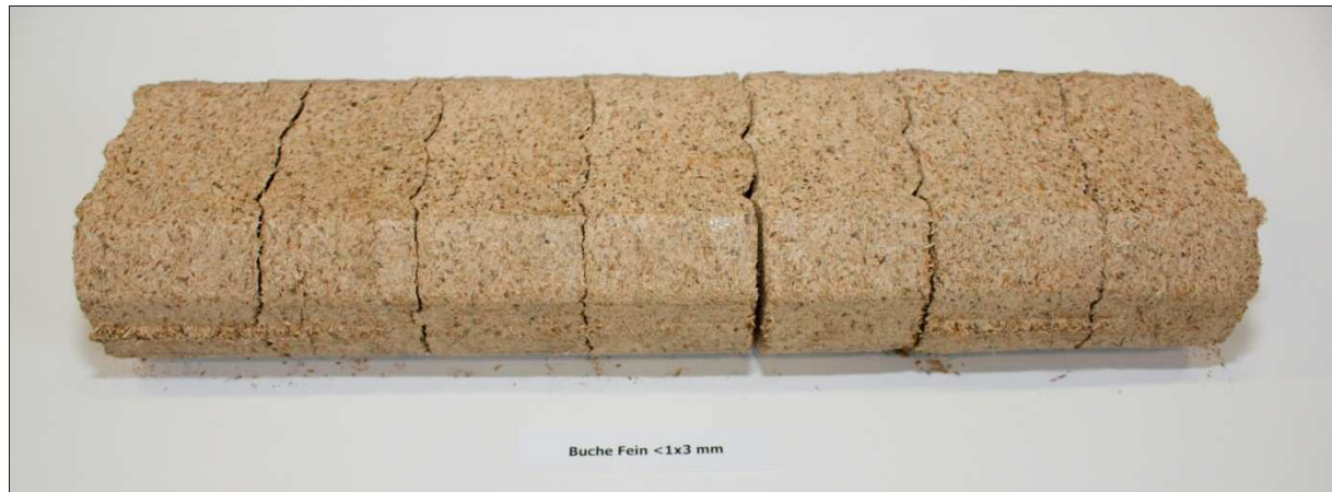
Abbildung 7-1: Brikettstrang bestehend aus sieben Briketts (Buchenwaldrestholz) (Foto: M.G.)
