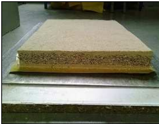
Abbildung 5-1: Spankuchen aus Waldrestholzspänen (Buche 7 cm bis 16 cm) nach ihrer Vorverdichtung (Foto: M.G.)
