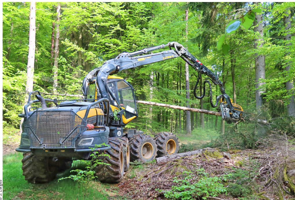
Abb. 1: Harvester bei der Rindenbehandlung von Fichtenstämmen. Die Vorschubwalzen und Entastungsmesser entfernen und quetschen den natürlichen Brutraum des Buchdruckers, vor allem bei mehrfachem Durchlaufen des Aggregats.
