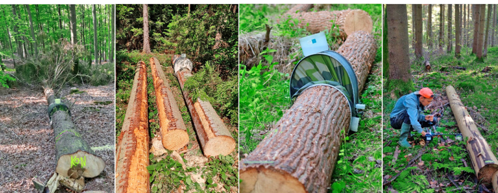
Abb. 2: Versuchsstämme mit unterschiedlichen Rindenbehandlungen (Kontrolle, Harvester dreifach, Motormanuelle gestreift und Handentrindet) mit Stammektoren und Bohrprobennahme.
