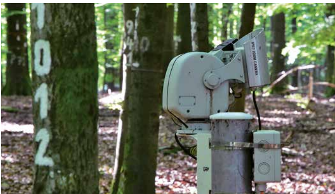
Kamera zur Erfassung der Phänologie
