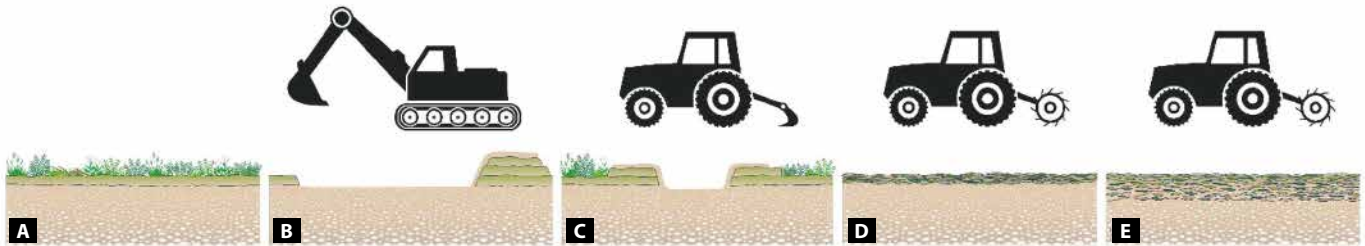
A = Kontrolle, B = Baggerräumung, C = Streifenpflug (Regionalverfahren im Hohen Fläming), D = Mulcher (Regionalverfahren im Ostbraunschweigischem Flachland), E = Fräse (Regionalverfahren im Hessischen Ried);
