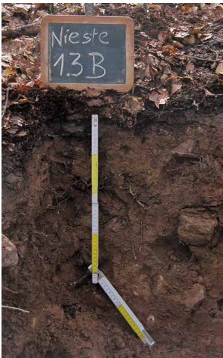
Das Profil 1.3B liegt im Totalreservat. Erkennbar ist eine erodierte, podsolige Braunerde über geringmächtiger toniger Wechselfolge (über Hardeggen-Basissandsteinfolge).
