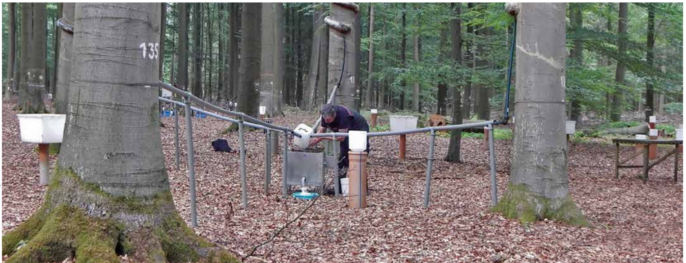
Stammablauf-Messanlage auf der Level II-Fläche Bornhöved
