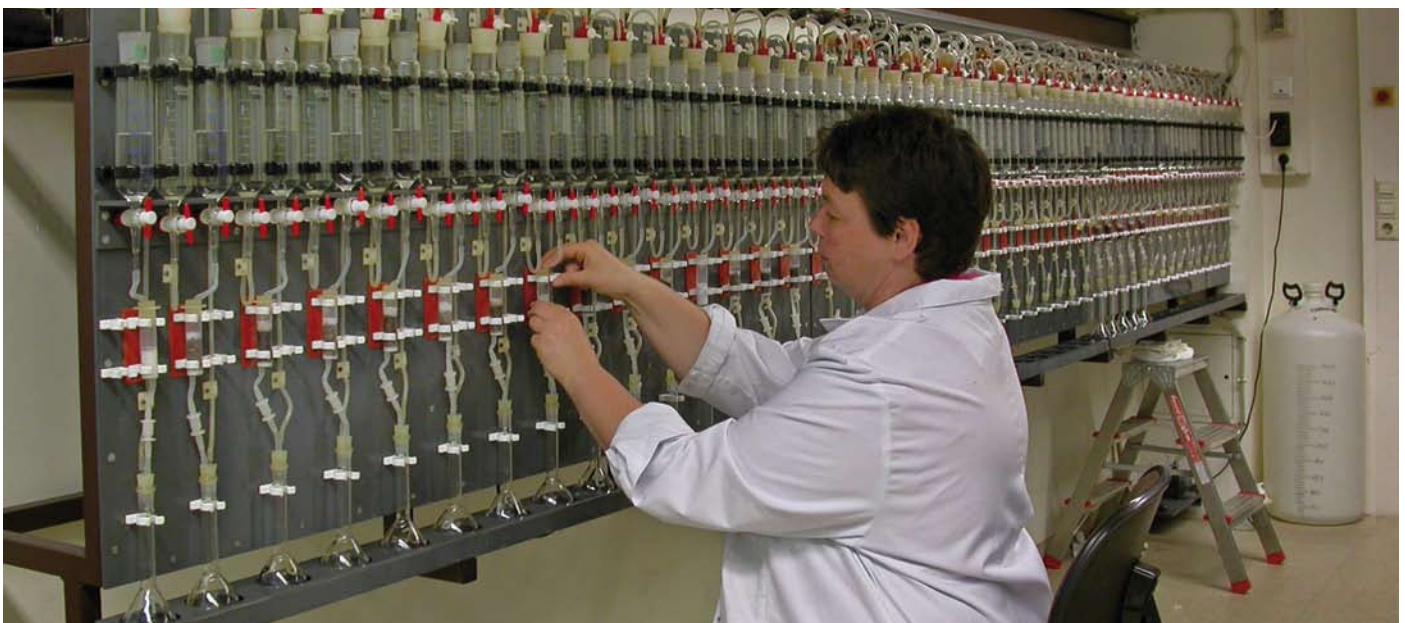
Extraktion von Bodenproben zur Bestimmung der Inhaltsstoffe
