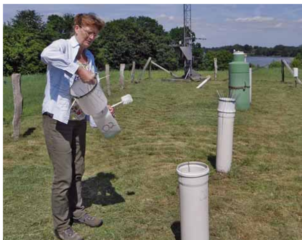
Niederschlagssammler, Freifläche Bornhöved Foto: O. Schwerdtfeger
