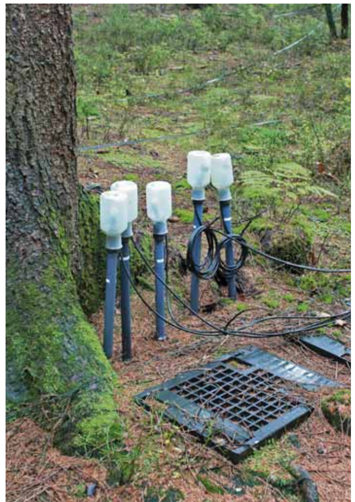
Messung der Bodenfeuchte
