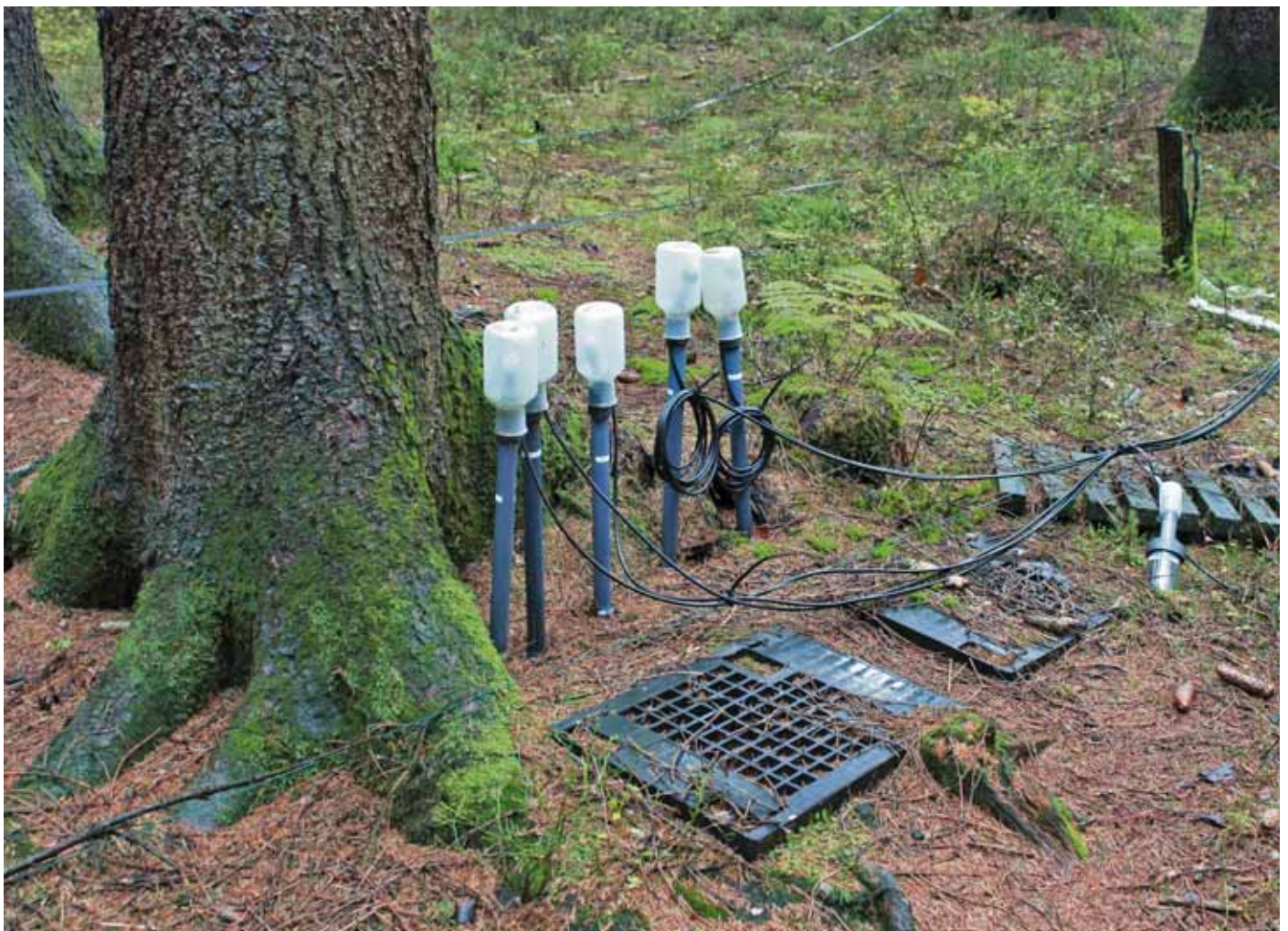
Messung der Bodenfeuchte auf der Intensiv-Monitoringfläche Solling, Fichte
