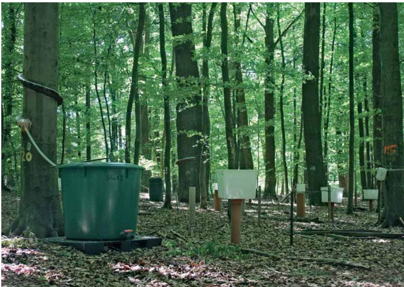
Stammablaufmessanlage und Stoffeintragsmessungen auf der Level II-Core-Fläche Lüss
