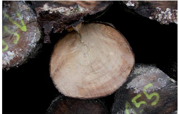
Abb. 2. Fichtenstamm-Hirnenden zum Aufnahmezeitpunkt Januar 2008 mit verfärbter Oberfläche nach rd. 10-monatiger Lagerung im Folienpolter sowie nach frischem Anschnitt (Mitte); Foto: Kielmann.
