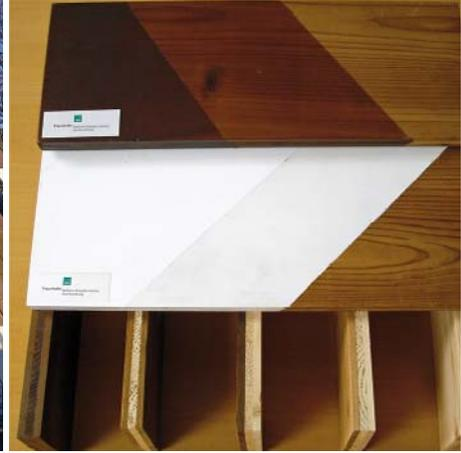
**ABB. 36** Bisher sind Fassadenplatten aus Holz nur begrenzt in der Lage, den Vorstellungen der Nutzer hinsichtlich Dauerhaftigkeit und Pflege gerecht zu werden. Daher sollte im Verbund WEFAM die Neuentwicklung einer großformatigen, mehrschichtigen Holzwerkstoffplatte erfolgen.
