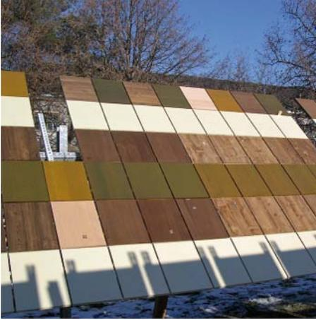
**ABB. 35** Wetterfeste Fassadenplatten aus modifiziertem Holz sind ein wichtiges Ziel im Verbund WEFAM. Zahlreiche Muster in verschiedenen Aufbauten müssen mit verschiedenen Anstrichen getestet werden, um die beste Kombination zu entwickeln.
