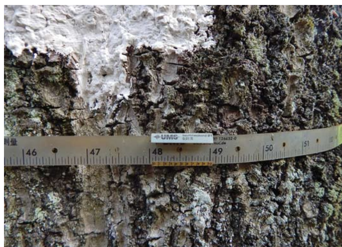
„Mitwachsendes“ Dauerumfangmessband zur millimetergenauen Erfassung des Dickenzuwachses Foto: O. Schwerdtfeger
