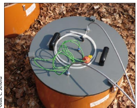
Abb. 2: Messkoffer mit Datenlogger, Temperaturmessgerät und Fühlern für Luft- und Bodentemperatur (links) sowie geschlossene Messkammer mit grauen Ein- und Ausgangsschläuchen zum \text{CO}_2 -Messgerät, weißem Überdruckschlauch und grünem Kabel zum Temperaturfühler im Deckel (rechts)
