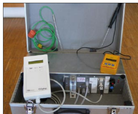
Abb. 2: Messkoffer mit Datenlogger, Temperaturmessgerät und Fühlern für Luft- und Bodentemperatur (links) sowie geschlossene Messkammer mit grauen Ein- und Ausgangsschläuchen zum \text{CO}_2 -Messgerät, weißem Überdruckschlauch und grünem Kabel zum Temperaturfühler im Deckel (rechts)
