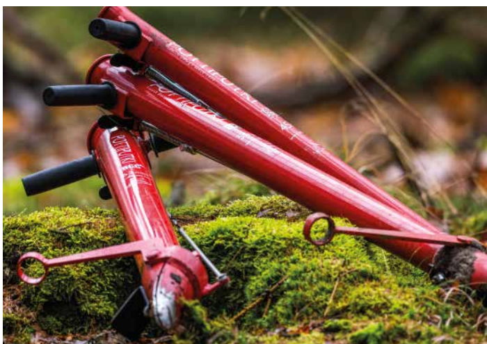
Das „Pottiputki“-Verfahren: Solche Pflanzrohre gibt es in unterschiedlichen Größen für verschieden große Container.
