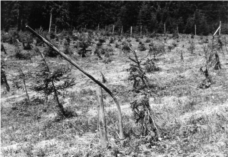
Abb. 2.9: Durch die Kraft des Schneeschubs wurden sogar Markierungspflöcke aus Eisenrohr verbogen (Foto: W. Ruetz 1975)
