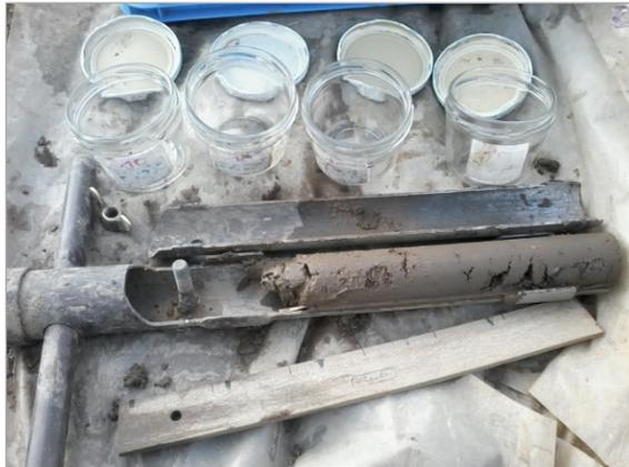
Abb. 11.3: Bodenstecher zur Entnahme der Kleinringelwurmproben auf Acker.
