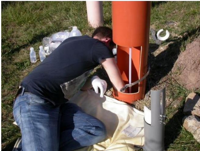
Abbildung 19: Probennahme: Herausheben der Probenflasche aus dem Probenraum
