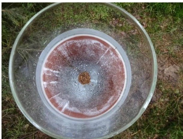
Abbildung 29: Sammeltrichter mit verschiedenen Streupartikeln
