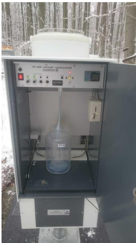
Abbildung 52: Innenansicht des klimatisierten Wet-only- (links) und des Bulk-Sammlers (rechts)
