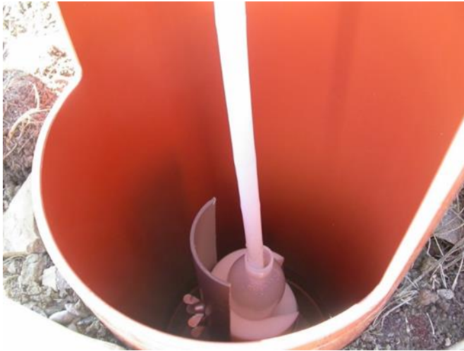
Abbildung 21: Flaschenhalter für die Trichterspülung im Probenraum
