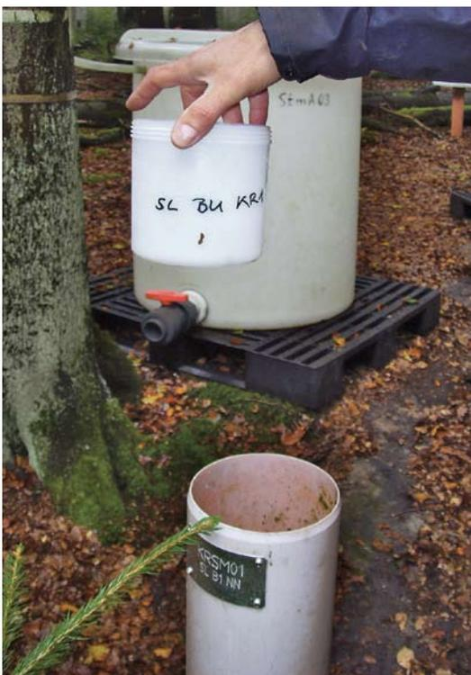
Entnahme eines Schwermetall-Sammelgefäßes Foto: NW-FVA
