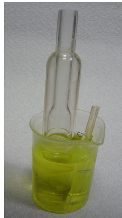
Das Quarzrohr und das Injektorrohr werden über Nacht im Abzug kopfüber in ein mit Königswasser gefülltes 250 ml Becherglas gestellt, am nächsten Morgen gründlich mit H<sub>2</sub>O demin. gespült und getrocknet. Nach dem Zusammenbau wird die Fackel vorsichtig (dazu die Abdeckung der Torchbox öffnen) wieder in seine Halterung eingebaut, wobei darauf geachtet werden muss, dass die Magnetspule nicht verbogen wird.
