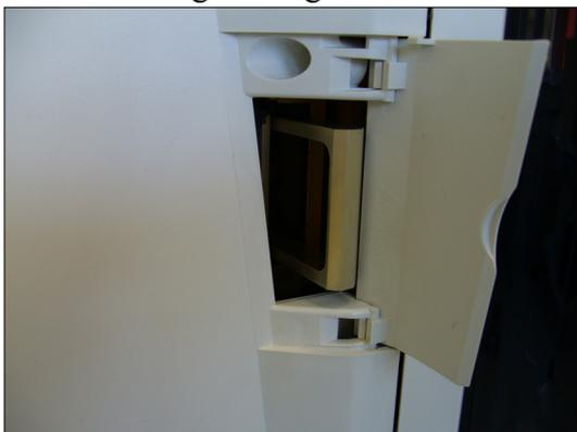
Zugang zum Eintrittsfenster erhält man durch eine Klappe, die sich links neben der großen Tür zum Probenraum befindet. Durch Herausziehen des Rahmens kann man die ca. 1.5 mm starke Quarzplatte inspizieren. Falls eine Reinigung erforderlich sein sollte, kann diese Platte nach Entfernung des Drahtrahmens herausgenommen werden. Die Reinigung könnte in einer Schale mit Königswasser erfolgen. Die Platte muss sehr vorsichtig behandelt werden (Reinigen und Trocknen), um sie
