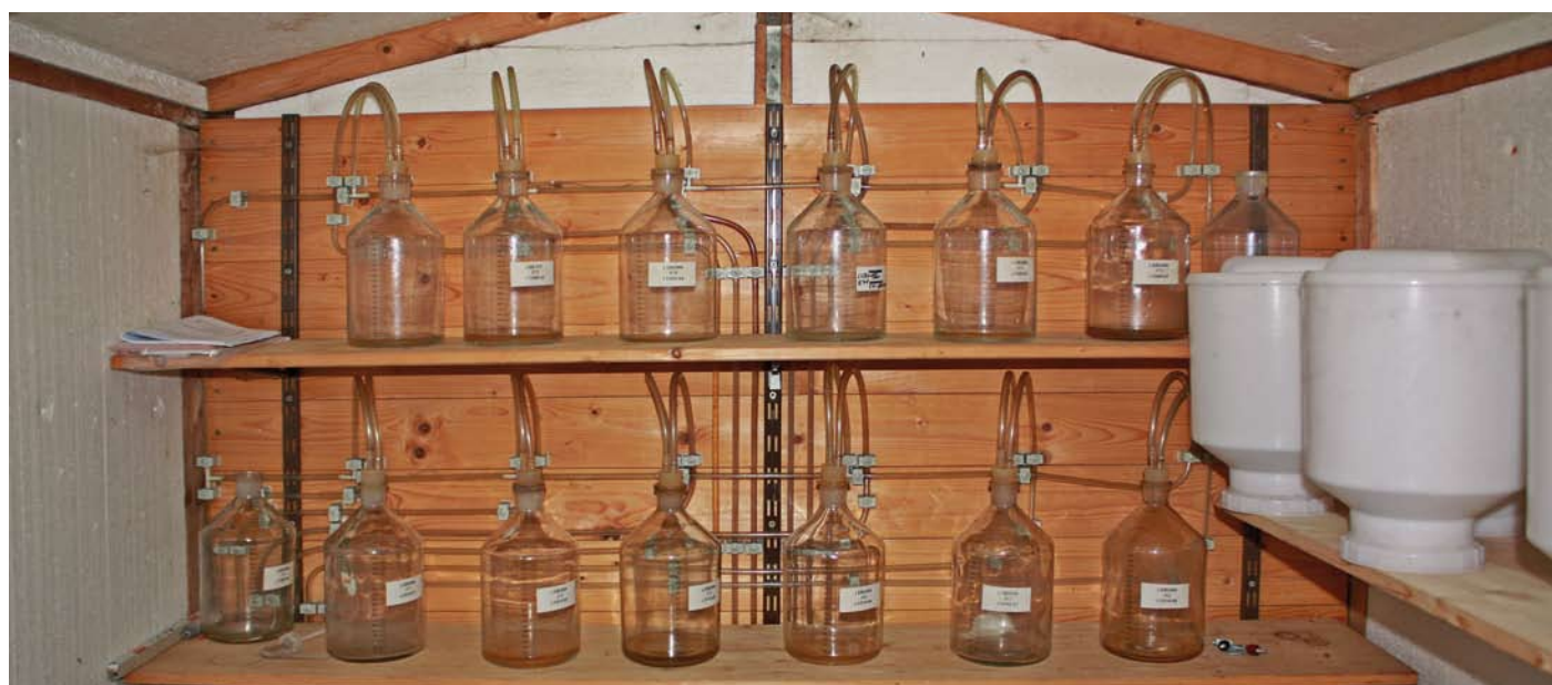
Mit Unterdruck wird Bodenlösung aus verschiedenen Tiefen gewonnen
