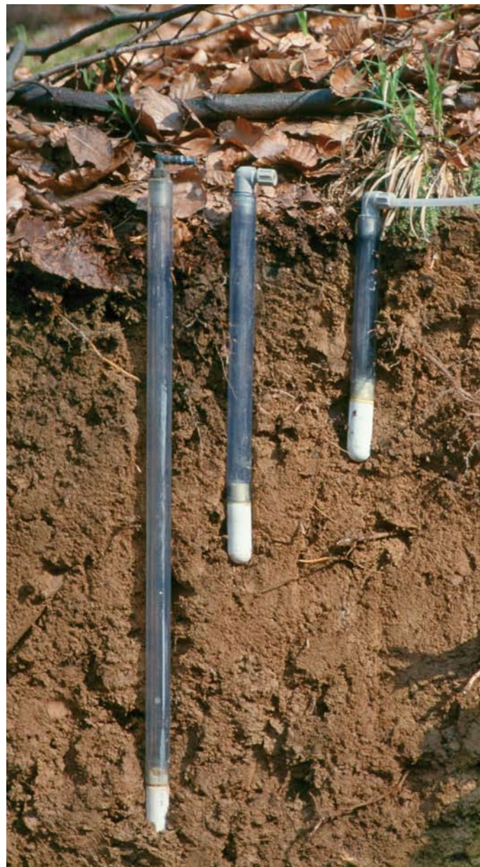
Saugkerzen zur Gewinnung von Bodenlösung in verschiedenen Tiefen Foto: NW-FVA
