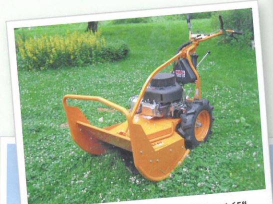
Abb. 3: Einachs-Mulchmäher „AS Scout 65“ (Foto: Kl. Wittschieben-Kück, NFA Harsefeld)
