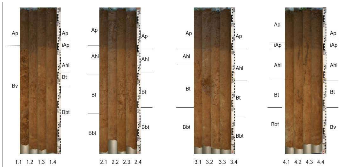
Abb. 1.2: Flächenprofile aus jeweils vier Rammkernen je Kernfläche und Horizontansprache, L001TIMM, 2. Wiederholungsinventur 2012.
