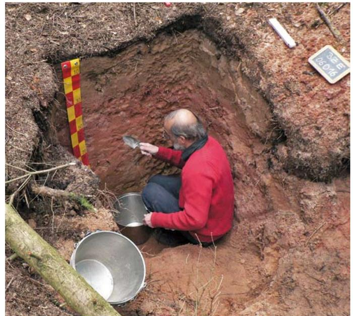
Bodenprobenahme an einer Profilwand
