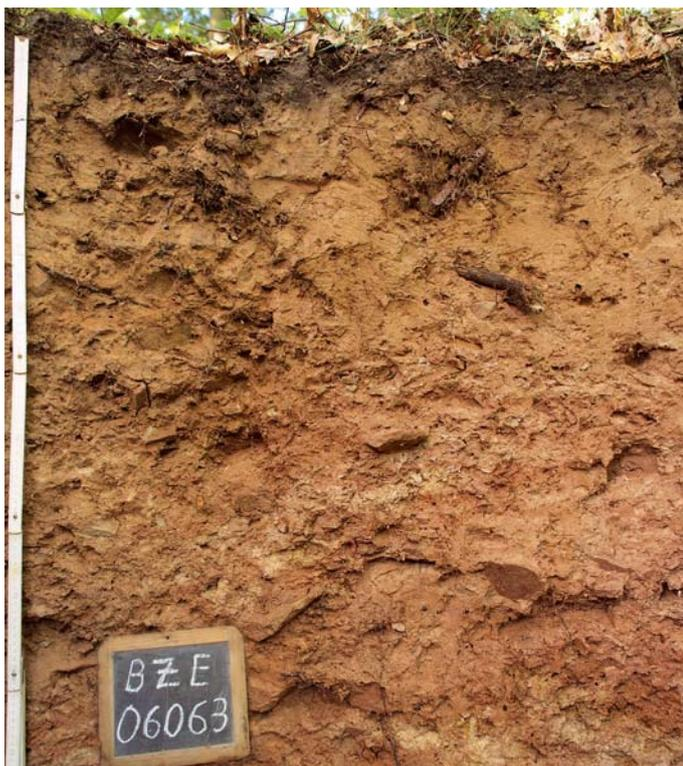
BZE-Buntsandsteinprofil bei Bebra in Nord-Osthessen: Verunreinigter Löss über einer Buntsandsteinfließerde Foto: NW-FVA
