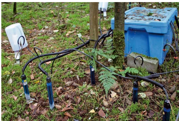
Tensiometer zur Messung der Bodenfeuchte
