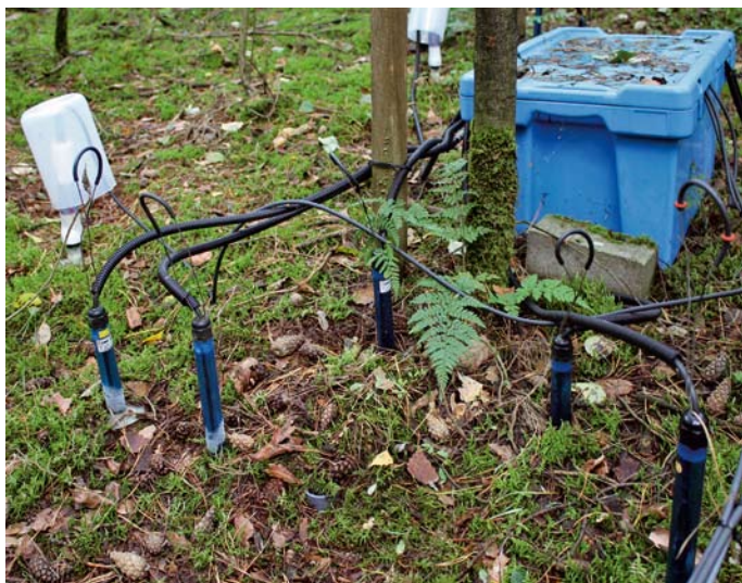
Tensiometer zur Messung der Bodenfeuchte
