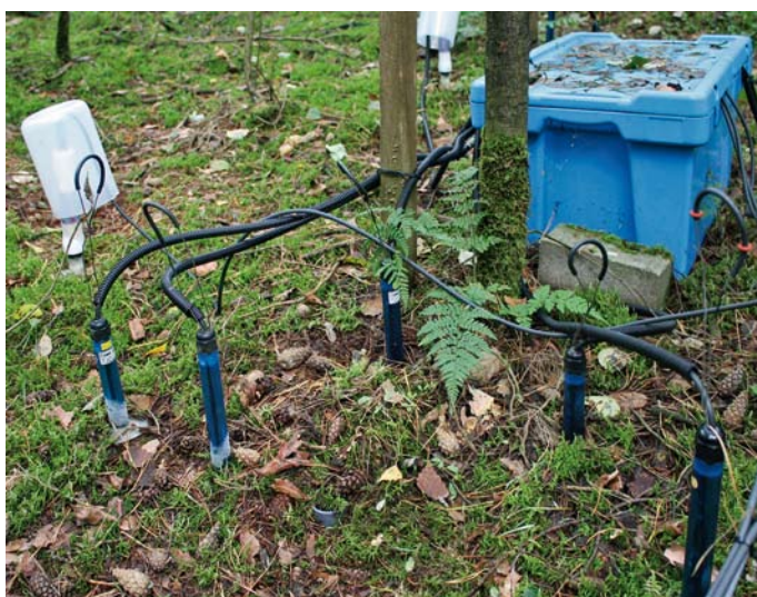
Tensiometer zur Messung der Bodenfeuchte
