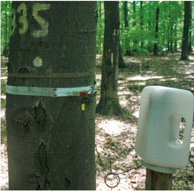
Kontinuierliche (Dendrometer) und periodische (Dauerumfangmessband) Zuwachsmessung im Intensiven Monitoring
