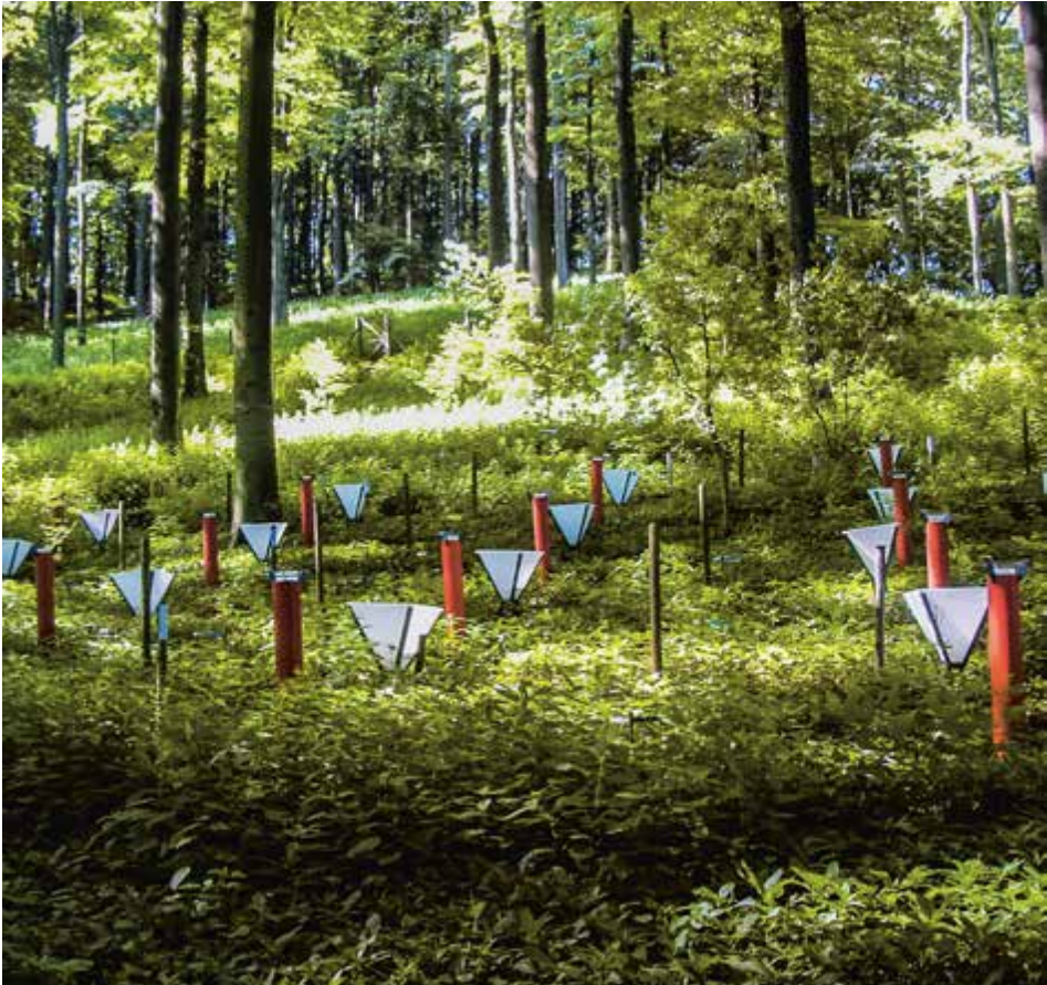
Abbildung 2: Buchenwald im Forstamt Wolfhagen (Intensivmonitoringfläche Zierenberg) mit Einrichtungen zur Messung von Deposition und Streufall.
