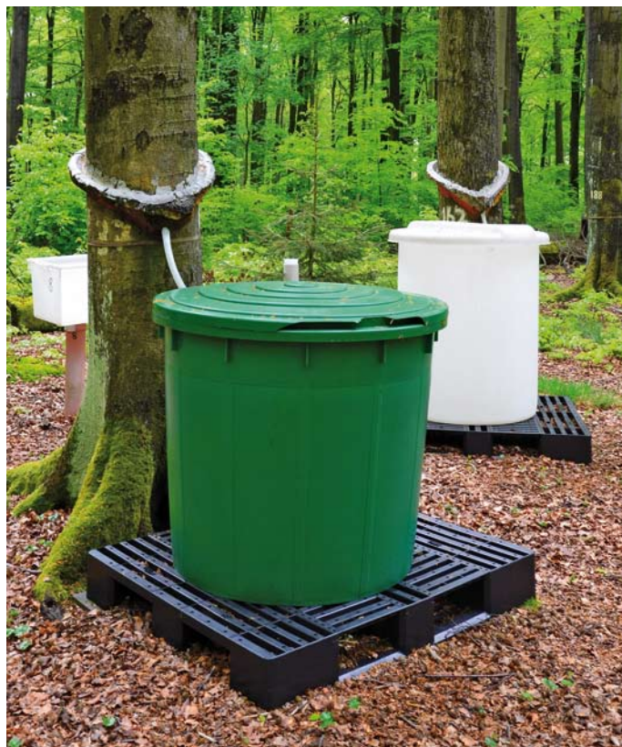
Stammablaufmessanlage auf der Level II-Fläche Solling, Buche Foto: H. Heinemann
