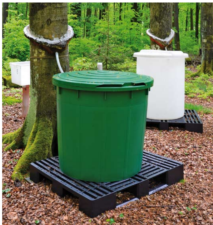
Stammablaufmessanlage auf der Level II-Fläche Solling, Buche Foto: H. Heinemann
