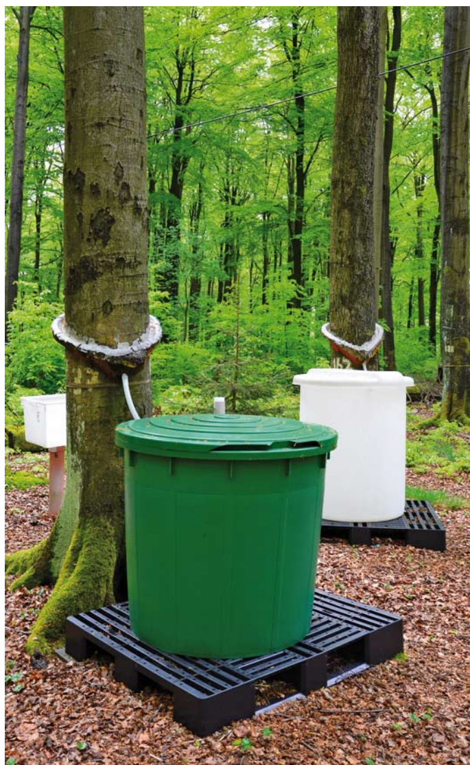
Stammablaufmessanlage auf der Level II-Fläche Solling, Buche Foto: H. Heinemann
