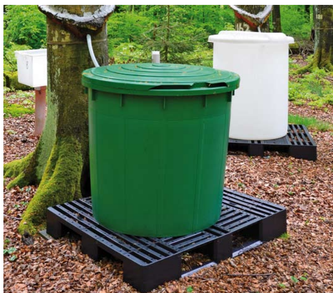
Stammablaufmessanlage auf der Level II-Fläche Solling, Buche Foto: H. Heinemann
