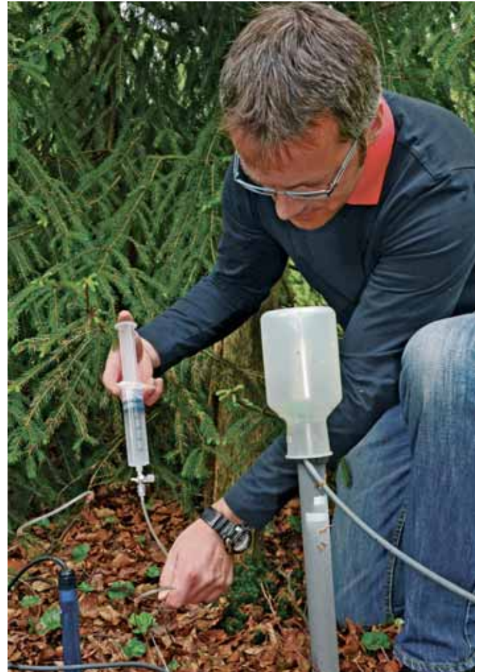
Wartung von Bodenfeuchtemessgeräten
