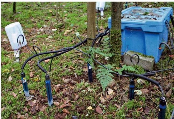
Tensiometer zur Messung der Bodenfeuchte
