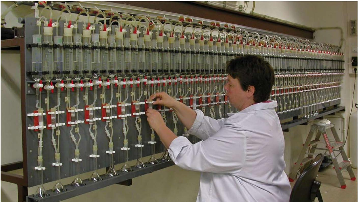
Extraktion von Bodenproben zur Bestimmung der Inhaltsstoffe
