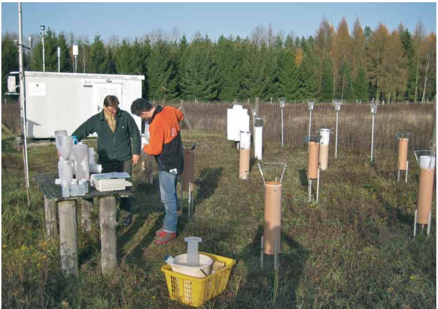
Leerung von Depositionssammlern auf der Freifläche der Level II-Fläche Klötze
