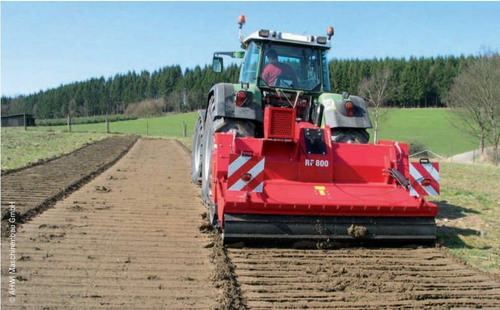
*Bodenfräse für die Wurzelstockrodung*
