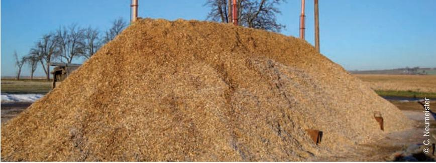
*Einlagerung von KUP-Hackgut mit Dombelüftungstrocknung. Erntefrisches Material weist einen Wassergehalt um 55 % auf. Durch eine Trocknung mit geeigneten Verfahren wird Lagerfähigkeit erreicht, die Transportwürdigkeit erhöht und auch der Einsatz in Kleinf Feuerungsanlagen ermöglicht.*
