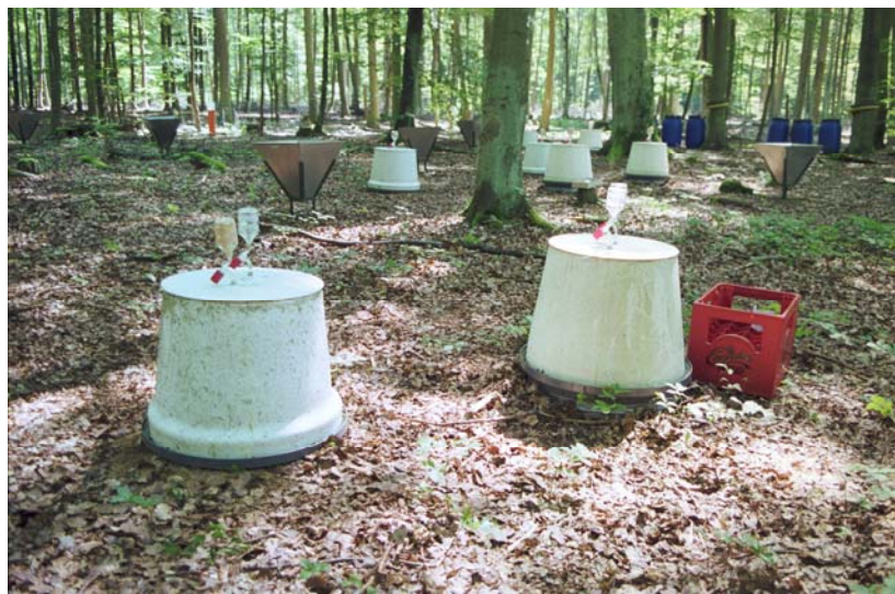
Abb. 17 Installation der Stahlrohre zum Wurzeltrenching (links) und Hauben zur Analyse der Bodenrespiration (rechts)
