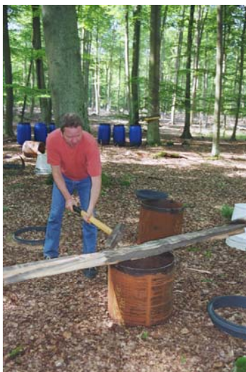
Abb. 17 Installation der Stahlrohre zum Wurzeltrenching (links) und Hauben zur Analyse der Bodenrespiration (rechts)
