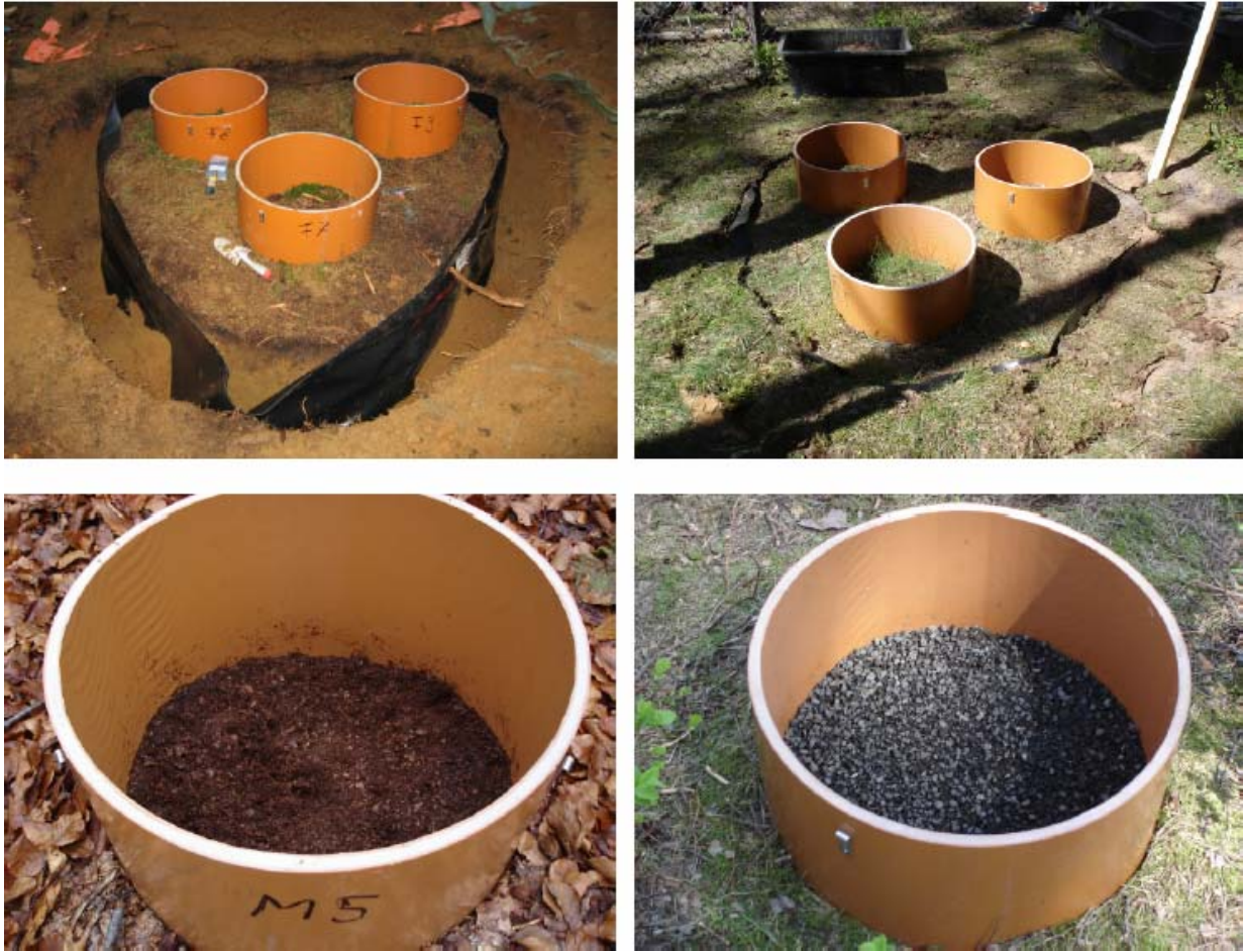
Abb. 11: Graben und Teichfolie bei Behandlungsvariante „Trenchen“ auf der Fläche Flossenbürg (links oben), getrennte Fläche nach Wiederauffüllen in Altdorf (rechts oben), Streuentnahme auf der Fläche Mitterfels (links unten) und Lava-Bruch in Messkammer in Altdorf (rechts unten)
