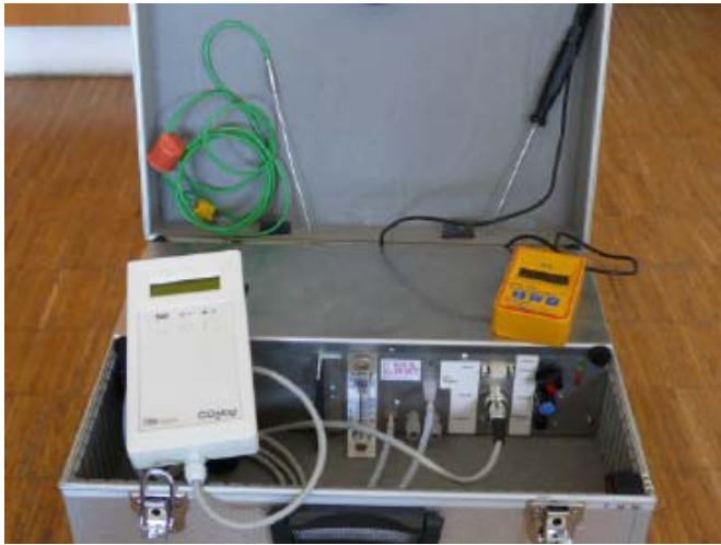
Abb. 9: Messkoffer mit Datenlogger, Temperaturmessgerät und Fühlern für Luft- und Bodentemperatur (links) sowie geschlossene Messkammer mit grauen Ein- und Ausgangsschläuchen zum CO 2 -Messgerät, weißem Überdruckschlauch und grünem Kabel zum Temperaturfühler im Deckel (rechts)
