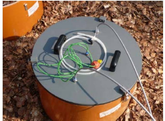
Abb. 9: Messkoffer mit Datenlogger, Temperaturmessgerät und Fühlern für Luft- und Bodentemperatur (links) sowie geschlossene Messkammer mit grauen Ein- und Ausgangsschläuchen zum CO 2 -Messgerät, weißem Überdruckschlauch und grünem Kabel zum Temperaturfühler im Deckel (rechts)
