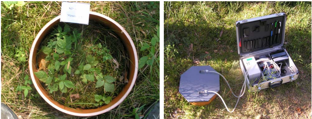
Abb. 22 Messkammer mit Bodenvegetation (links) und Infrarot-Analysator (rechts)
