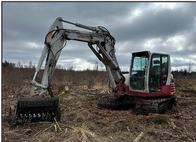
Abbildung 9: Kleinbagger während des bodennahen Mulchens auf der Fläche der Variante 2-1 (links). Gemischte Schafherde im April während des ersten Auftriebs (rechts). Foto: A. Wittenberg
