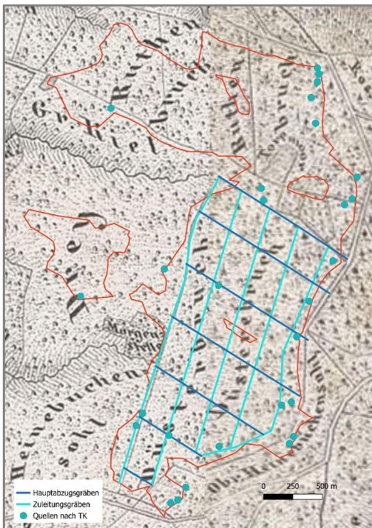
Abbildung 5: Das ab 1847 angelegte Grabennetz aus Hauptabzugsgräben und Zuleitungsgräben im Düsteren Bruch, projiziert auf die Papen-Karte von 1842. Mit dargestellt sind Quellen sowie der Waldmoor-Komplex Wildenkiel insgesamt (rote Umrandung)
