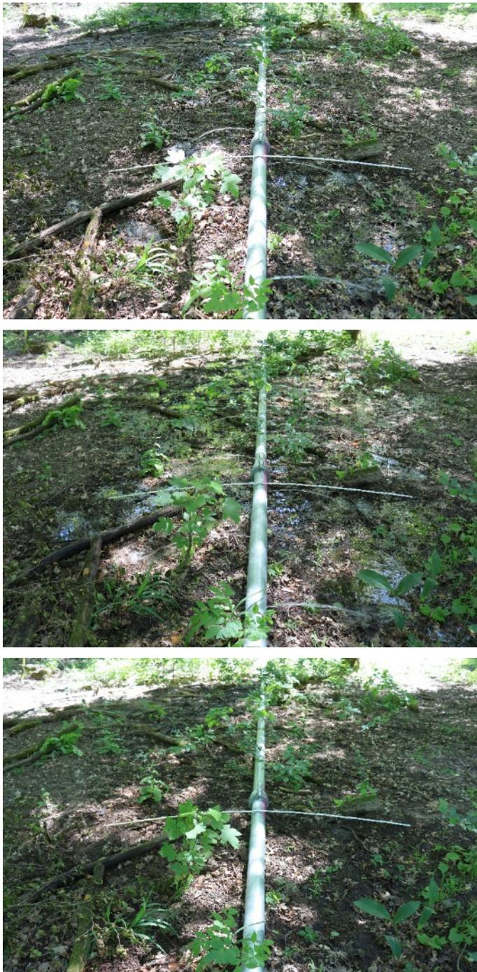
Abbildung 10: Oberflächliche Wasserausbreitung und Infiltration 20 min (oben) und 120 min (Mitte) nach Beregnungsstart und etwa 15 Minuten nach der Beregnung (unten) auf Parzelle 6 (5 Bewässerungsleitungen) am 01.06. 2021. Es wurden 80 mm beregnet. Ein ausgeklappter Zollstock senkrecht zur Bewässerungsleitung dient zum Abschätzen der Ausbreitung des Wassers.
