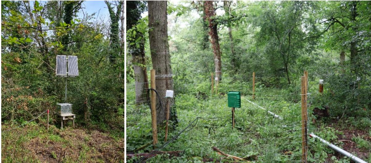
Abbildung 1: Loggeranlage mit Solarpanel und gezäuntes Messfeld
