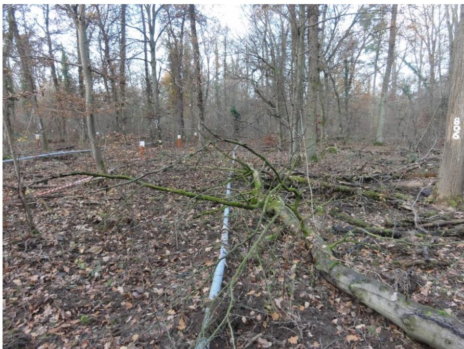
Abbildung 20: Umgestürzter Baum über Rohrstrang auf Parzelle Zu6
