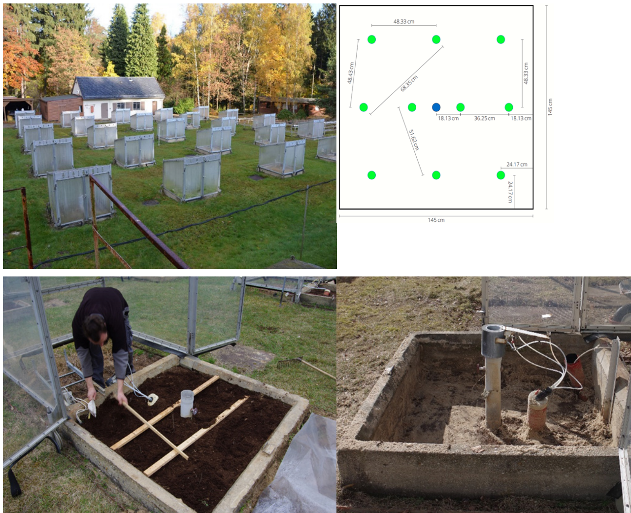
Abbildung 31: (oben links) Aufbau des ökologischen Prüffelds, (oben rechts) Pflanzmuster der Eschen in den Kabinen. Grüne Kreise stehen für Eschen, der blaue für das 15 cm KG-Rohr der Lüftung, (unten links) Hilfsmittel erlaubten die Eschen exakt gemäß dem Muster zu pflanzen, (unten rechts) Ansicht der Kabinen, nachdem 30 cm ausgehoben sind. Später wurden die Kabinen mit Pflanzerde wieder aufgefüllt.
