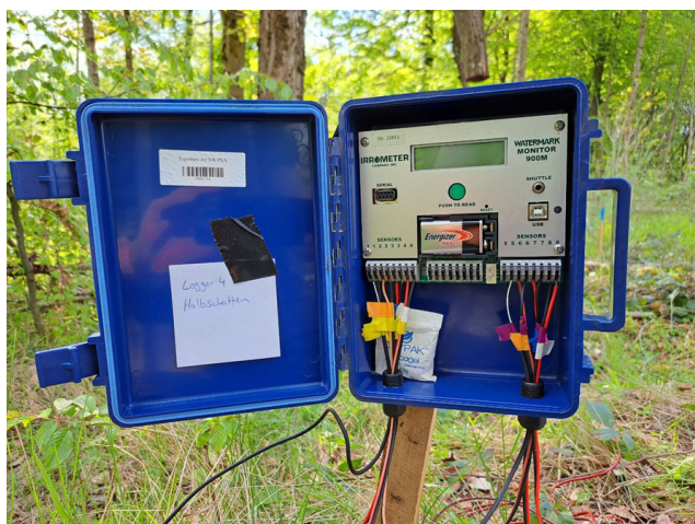
Abbildung 15: Bodenfeuchtelogger (links) und Logger zur Messung von Temperatur und Luftfeuchte in 1 m Höhe (Fotos: J. Osewold)
