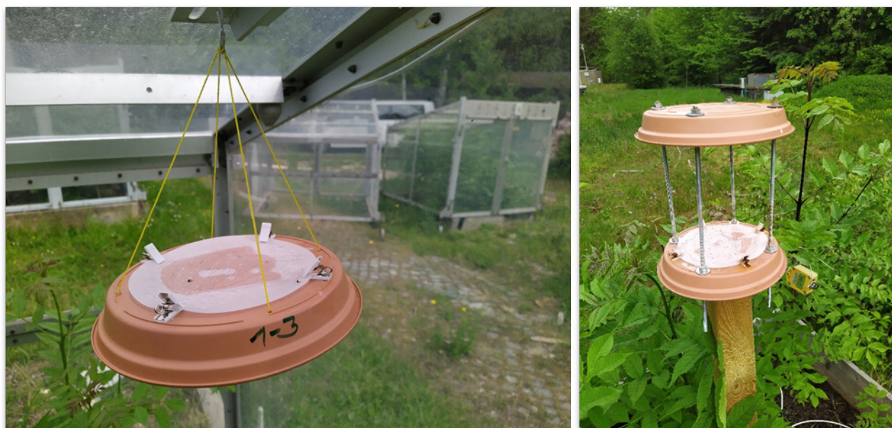
Abbildung 33: Passive Sporenfallen in der hängenden Ausführung [links] für Verwendung in der Gewächshauskabine sowie mit Dach für die Anwendung im Freiland [rechts]
