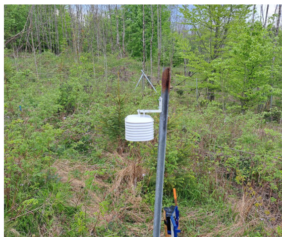
Abbildung 15: Bodenfeuchtelogger (links) und Logger zur Messung von Temperatur und Luftfeuchte in 1 m Höhe (Fotos: J. Osewold)
