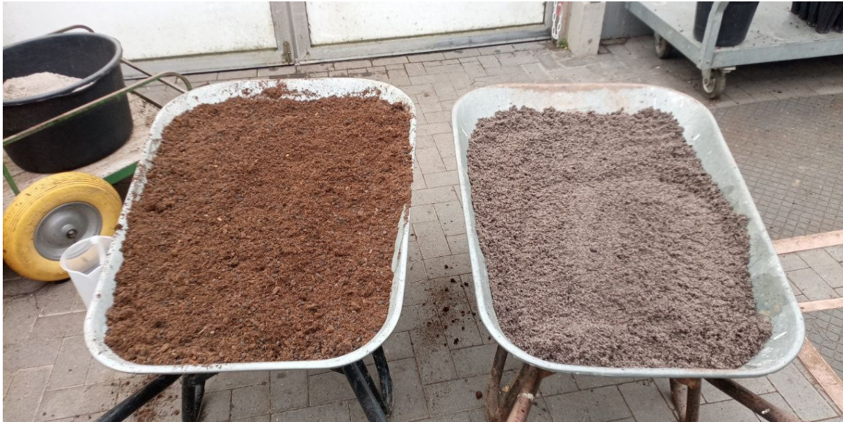
Abbildung 13. Unbehandeltes Substrat (links) und daraus erzeugtes Mischsubstrat mit 50 % Sandanteil (rechts).
